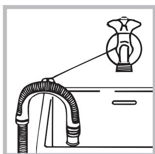
або розташуйте його на краю вмивальника чи ванної, приєднавши направляючу з комплекту до крану (див. малюнок). Не залишайте вільний кінець зливного шланга зануреним у воду.
