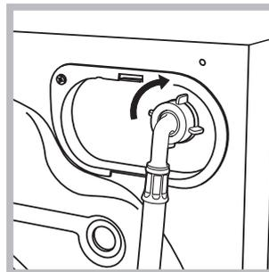
2. Підключіть шланг подачі води до пральної машини, під'єднавши його до водорозбірного крану, який знаходиться угорі праворуч на задньому боці машини (див. малюнок).
